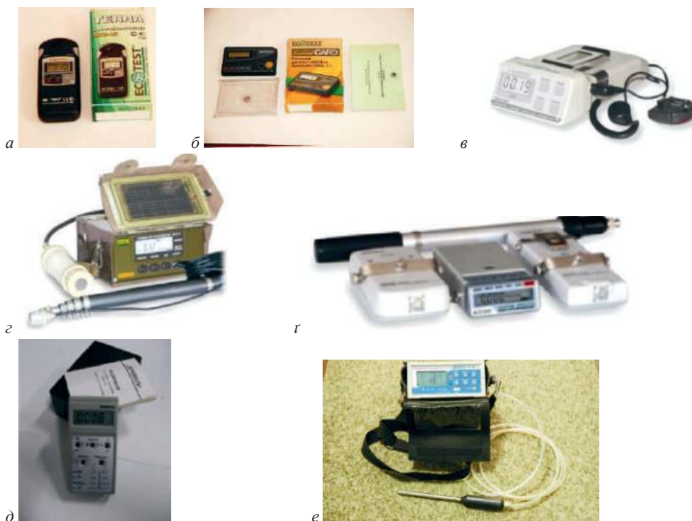
Іл. 28.14. Прилади для оснащення поста РХС:
