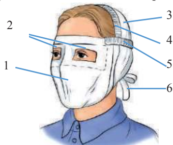
Іл. 27.4. Протипилова тканинна маска ПТМ-1: 1 — корпус маски; 2 — оглядові отвори; 3 — кріплення; 4 — гумова тасьма; 5 — поперечна гумова смужка; 6 — зав'язки
