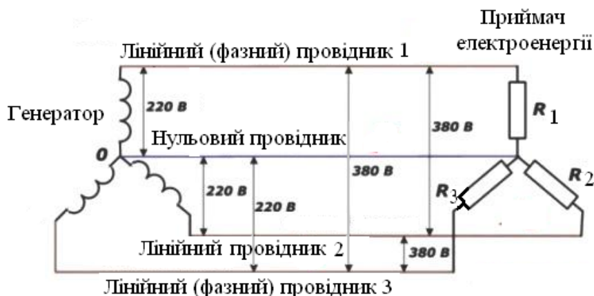
Рисунок 4.9 – Фазні та лінійні напруги трифазної електричної мережі
