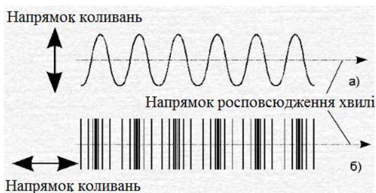
Рисунок 4.47 – Поперечна та поздовжня хвиля
