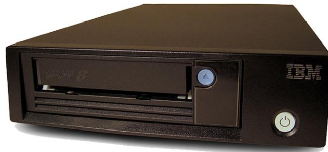
Рисунок 2.1. Стрічковий накопичувач LTO-8, має інтерфейс SAS 6 Гбіт/с
