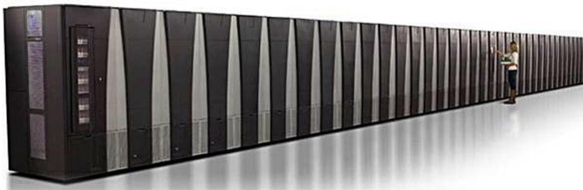
Рисунок. 2.3 Стрічкова роботизована бібліотека Spectra Logic TFinity ExaScale
