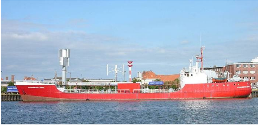
Рисунок 6.40 – Німецький танкер Hydrogen Challenger (водень виробляється на борту за рахунок енергії вітру) (Водородный транспорт, 2017)
