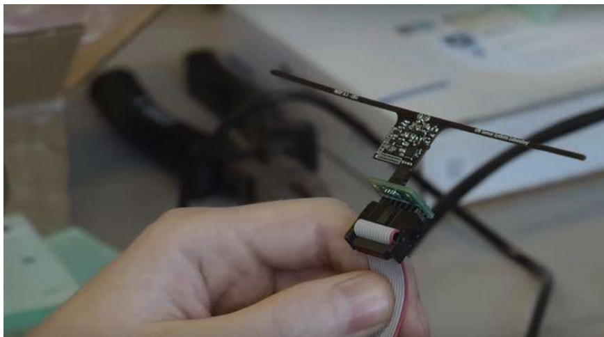
Рисунок 5.17– WISP-енергія – і електромагнітних хвиль (Atherton, 2016)
