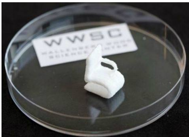
Рисунок 4.11 – Предмет, надрукований на 3D-принтері «чорнилом» із целюлози (Доронин, 2015 б)
