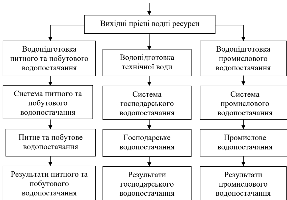
Рис. 6. Структура системи прісноводного водопостачання під час здійснення питного, побутового та господарсько-промислової діяльності
